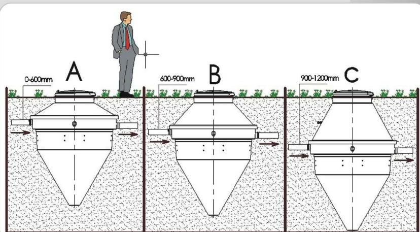
**Возможен монтаж оборудования под проезжей частью, а также при заглублении канализационной трассы до 2,5 м от поверхности земли.**
